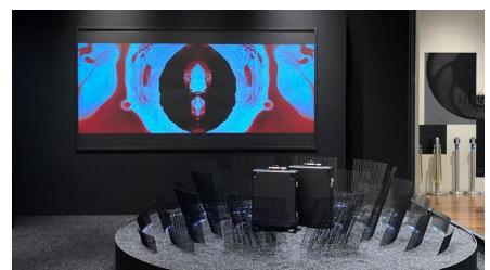
LED TOKYOは、特設されたポップアップストアのメインモニターとして、高精細2.97ミリピッチ、横3メートル×縦1.5メートルのLEDビジョンを設置しました。
